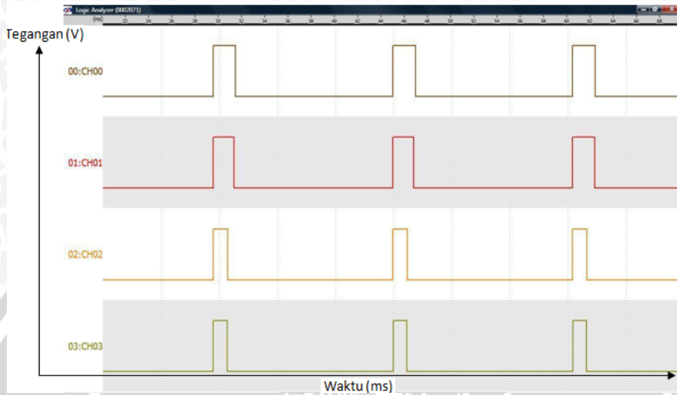
Gambar 5. 10 Bentuk Sinyal Keluaran Saat Pitch Ke Depan
