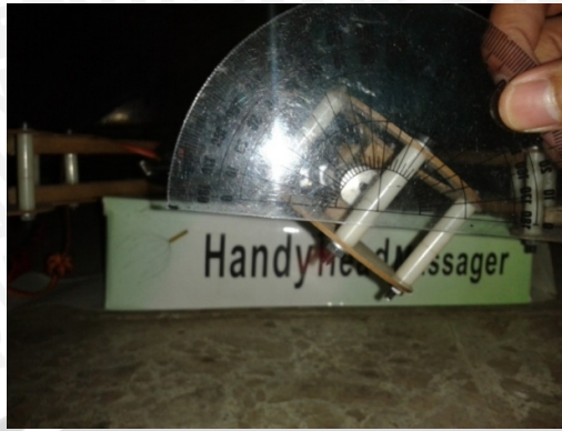
Gambar 5. 7 Pengujian Motor Servo dengan Tuas Rudder 100% ke Kanan Didapatkan Sudut 32°.
