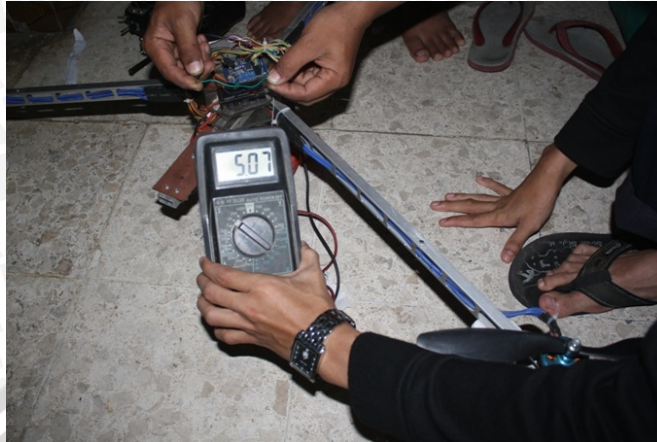
Gambar 5. 2 Pengujian BEC pada ESC 18 A Tower Pro.
