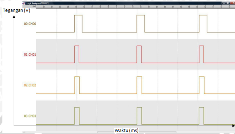
Gambar 5. 8 Bentuk Sinyal Keluaran Saat Roll Ke Kiri
