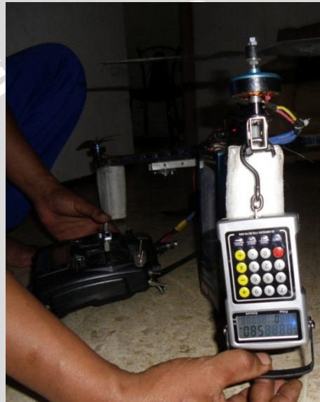
Gambar 5. 5 Foto Pengujian Motor Brushless DT750.
