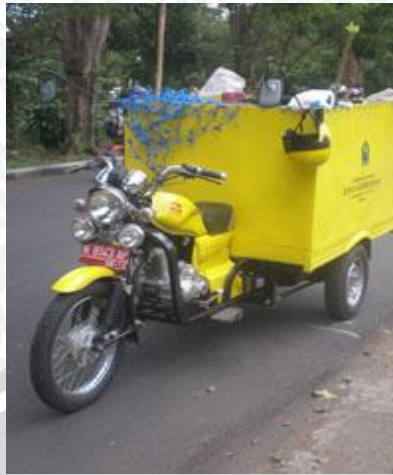
Gambar 4.34. Motor gerobak dengan kapasitas angkut 2\text{m}^3
