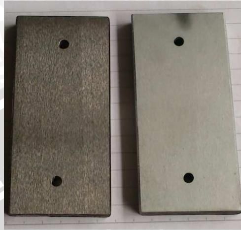
Gambar 4.1 Spesimen tanpa perlakuan dan setelah *hard chrome*
