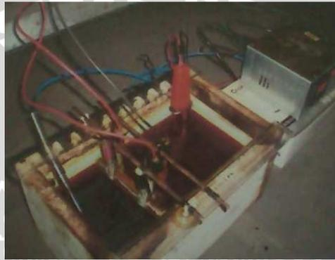
Gambar 3.7 Bak Elektrolisis
