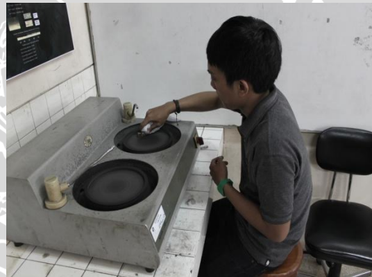
Proses persiapan foto mikrostruktur
