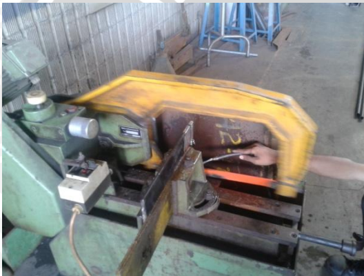
Proses pemotongan hasil las
