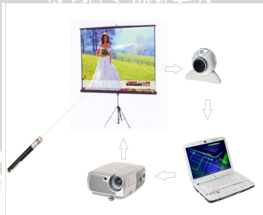
Gambar 3.1 Rancangan Sistem Pendeteksi Laser Pointer Secara Keseluruhan
