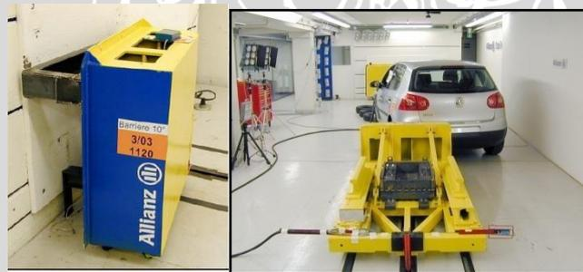
Gambar 2.6 Standar RCAR untuk uji bumper kendaraan
