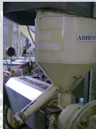
Gambar 2.16 Extruder Adhesive Sumber : PT . X
