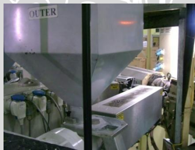
Gambar 2.14 Hopper Outer Sumber : PT . X
