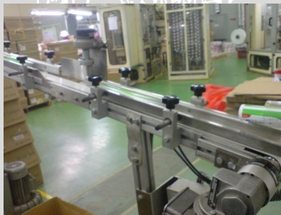
Gambar 2.10 Body Conveyor Sumber : PT . X
