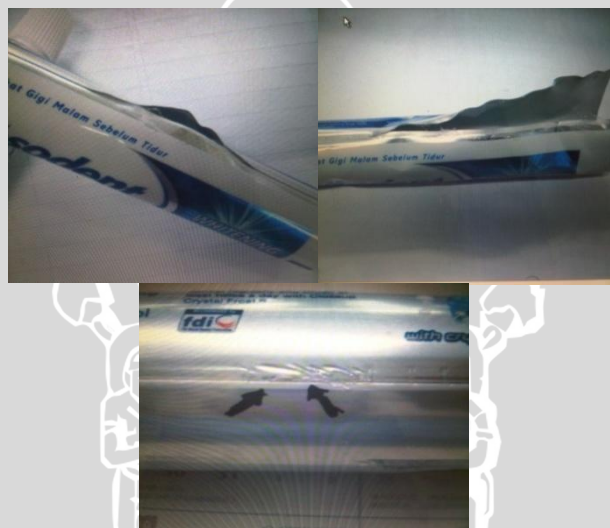
Gambar 2.32 Kerusakan pada side seam Sumber : PT. X
