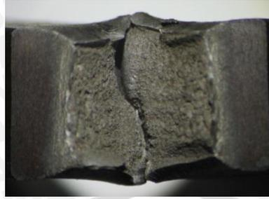
Spesimen Tanpa Perlakuan Panas (Temperatur Pengujian 100°C)
