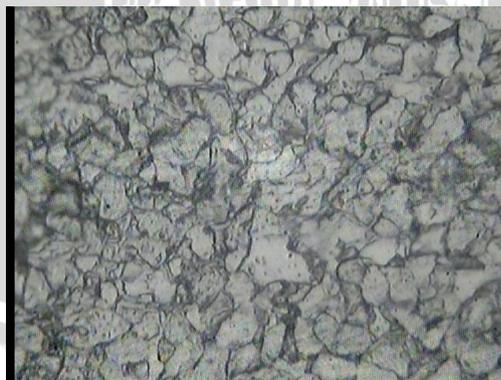
Gambar 4.3 Foto Mikro Spesimen *Tempering* dengan Temperatur  $200^{\circ}\text{C}$
