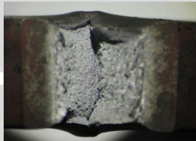
Spesimen *Tempering* dengan Temperatur 300°C (Temperatur Pengujian 63°C)
