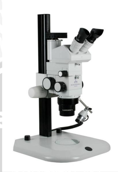
Gambar 3.8 Mikroskop Logam
