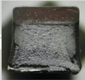
Spesimen *Tempering* dengan Temperatur 200°C (Temperatur Pengujian 100°C)
