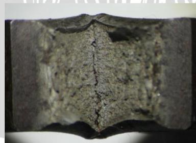
Spesimen *Tempering* dengan Temperatur 400°C (Temperatur Pengujian -25°C)
