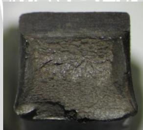
Spesimen *Tempering* dengan Temperatur 200°C (Temperatur Pengujian 27°C)
