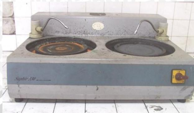
Gambar 3.4 *Centrifugal Sand Paper Machine*
