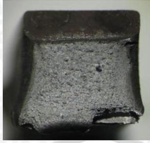
Gambar 4.8 Foto Makro Patahan Spesimen *Tempering* dengan Temperatur  $300^{\circ}\text{C}$
