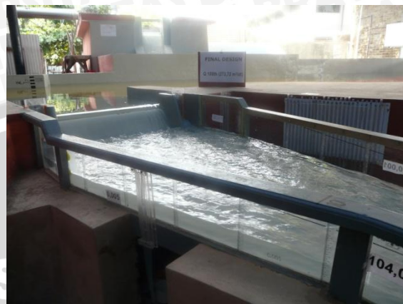
Foto 6. Kondisi Aliran pada Saluran Transisi
