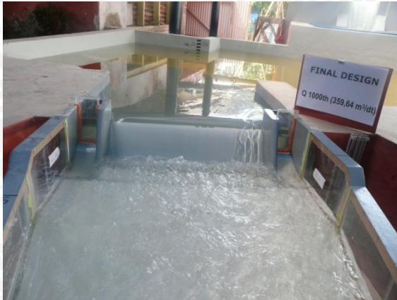
Foto 9. Kondisi Aliran pada Pelimpah
