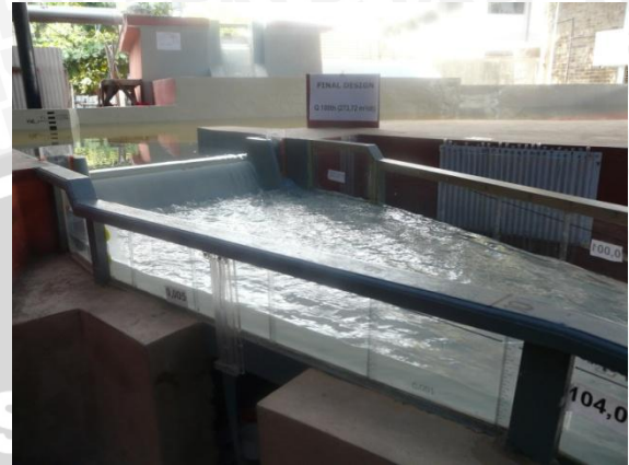
Foto 10. Kondisi Aliran pada Saluran Transisi
