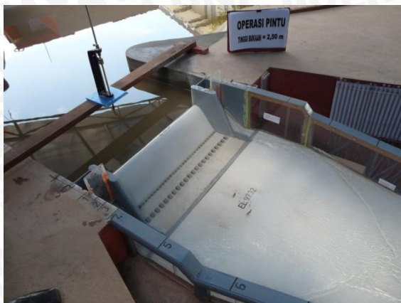
Foto 29. Kondisi Aliran pada Pelimpah
