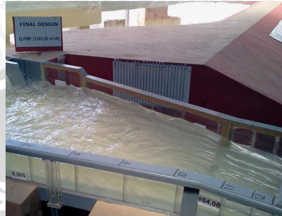
Foto 14. Kondisi Aliran pada Saluran Transisi
