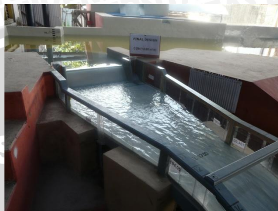
Foto 2. Kondisi Aliran pada Saluran Transisi
