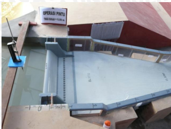
Foto 17. Kondisi Aliran pada Pelimpah
