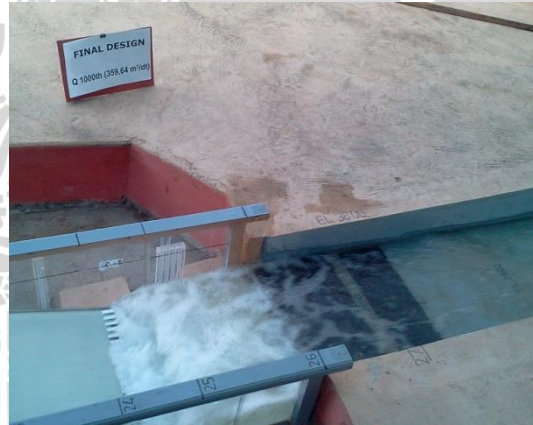
Foto 12. Kondisi Aliran pada Stilling Basin
