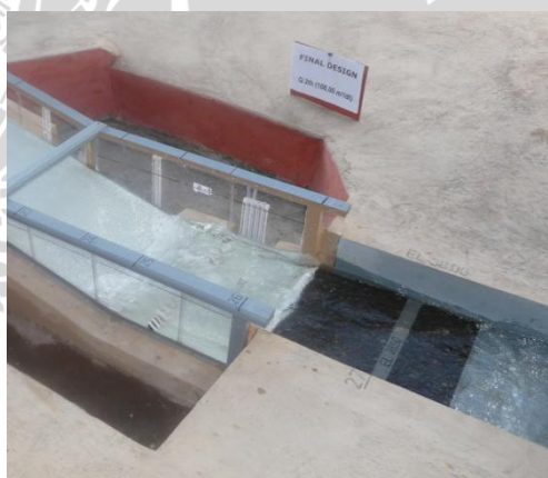
Foto 4. Kondisi Aliran pada Stilling Basin
