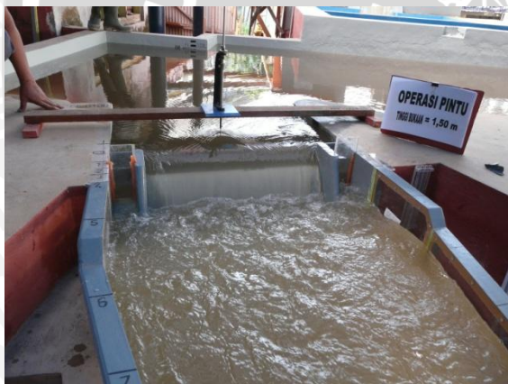
Foto 27. Kondisi Aliran pada Pelimpah
