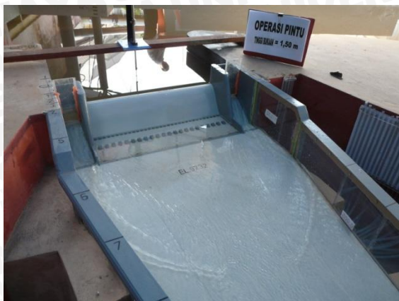
Foto 25. Kondisi Aliran pada Pelimpah
