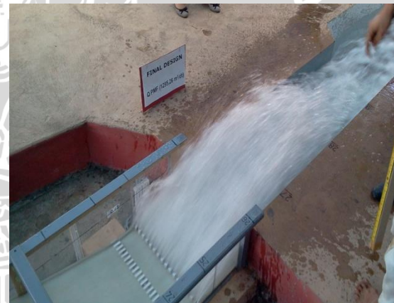
Foto 16. Kondisi Aliran pada Stilling Basin
