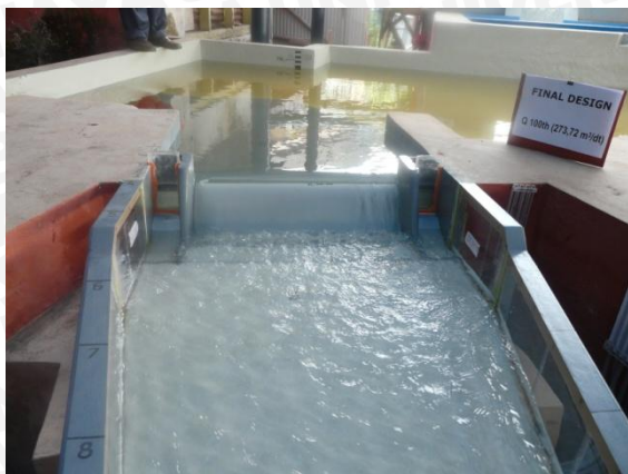
Foto 5. Kondisi Aliran pada Pelimpah
