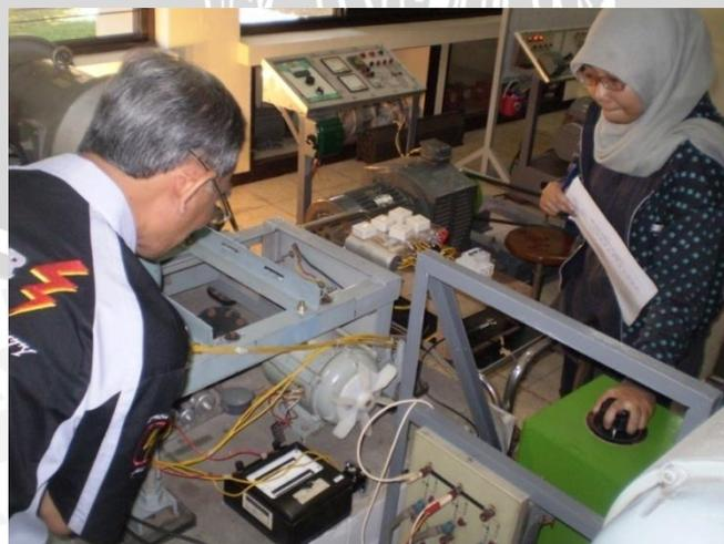
Pengujian Generator Induksi Satu Fasa di Laboratorium
