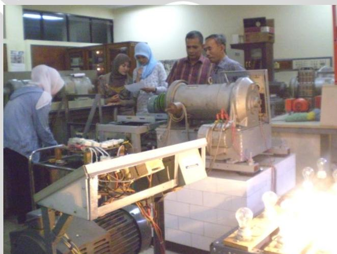
Pengujian Generator Induksi Satu Fasa di Laboratorium
