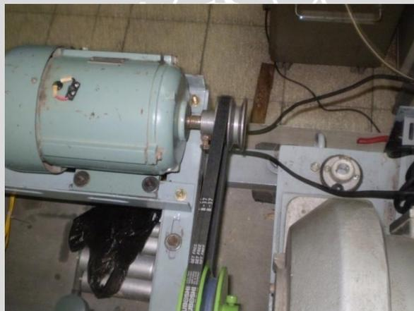
Kopel Motor Induksi Satu Fasa Dengan Motor Penggerak
