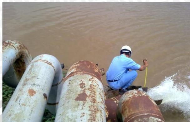
Pengukuran Ketinggian Pipa Pembuangan dari Permukaan Air ke Bagian Bawah Pipa
