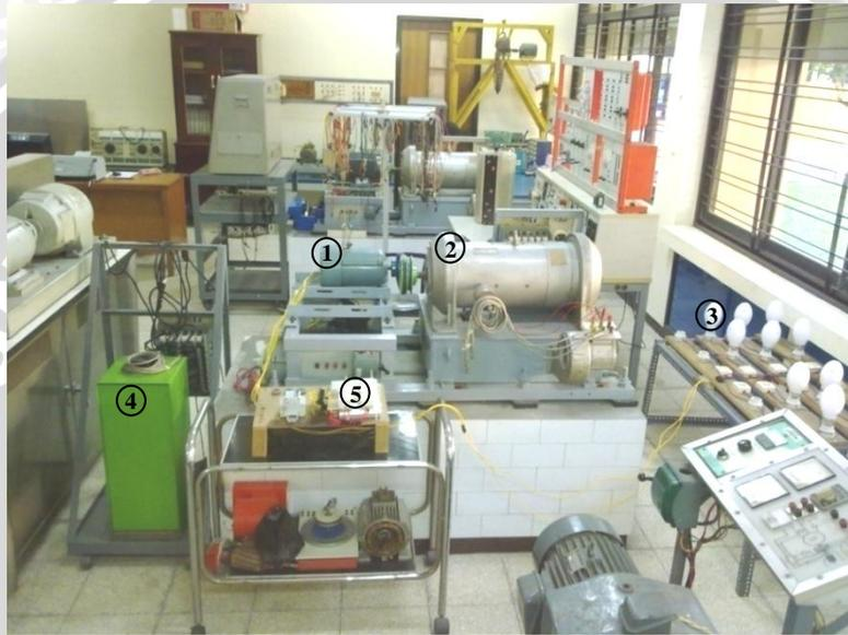
**Gambar 5.1 Pengujian Generator Induksi Satu Fasa Di Laboratorium**
