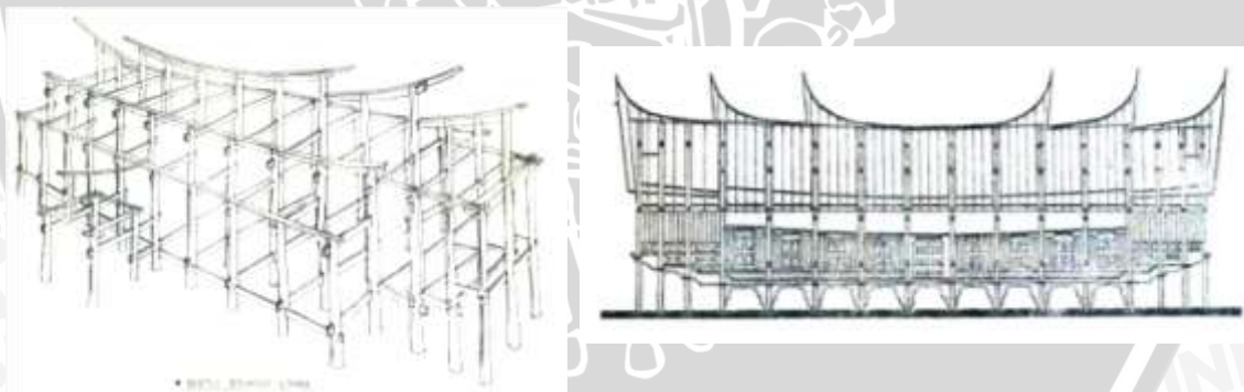
Gambar 2.14. Sketsa struktur utama dan potongan Rumah Gadang Sumber: Setiyowati (-)
