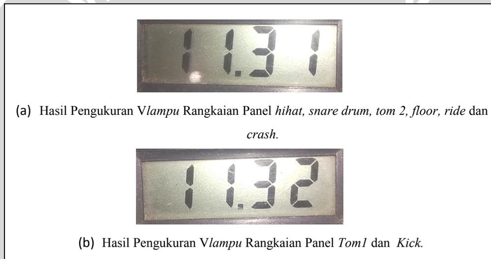
Gambar 5.13 Hasil Pengukuran Pengujian Rangkaian Panel Penampil.
