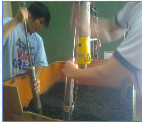
Gambar 3.4 Pemadatan dengan proctor standart
