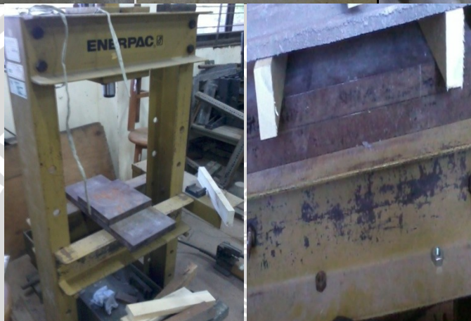
Gambar Lampiran 18 Alat-alat uji kuat lentur (dari kiri-kanan): dial gauge , proving ring , batang kayu pembebanan (2,5 x 6 cm), alat uji kuat lentur, dan dua batang kayu penumpu (2,5 x 6 cm).
