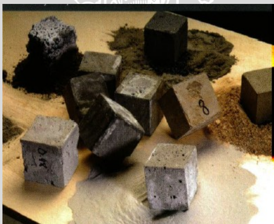
Gambar 2.4 Sampel dari cenocell yang dibuat dengan variasi komposisi kimia dan waktu curing .
