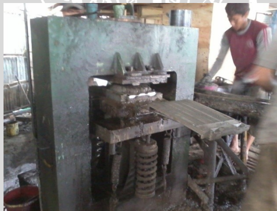
Gambar 4.5 Proses pencetakan genteng beton dengan mesin hidrolis.
