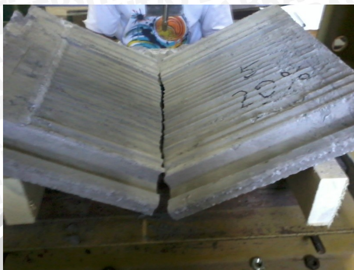
Gambar Lampiran 22 Kondisi genteng beton setelah pengujian kuat lentur.
