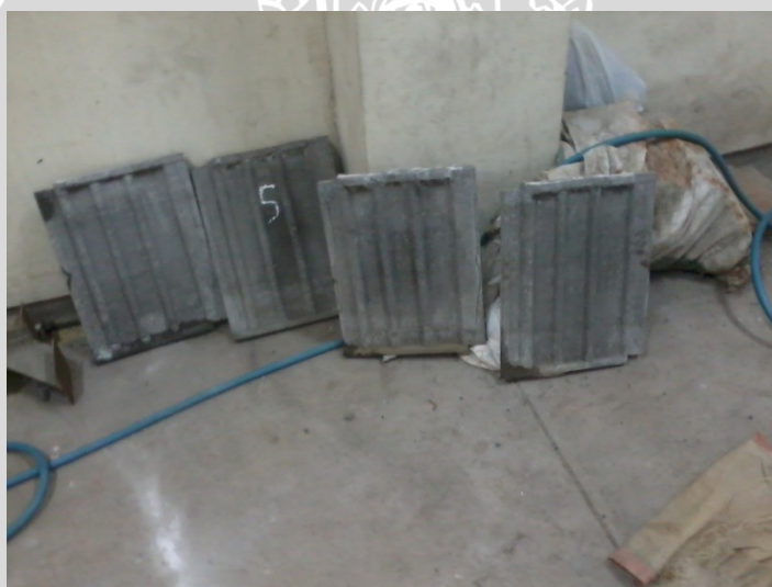
Gambar Lampiran 23 Kondisi genteng beton setelah pengujian impermeabilitas.
