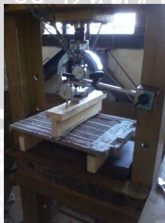
Gambar 4.8 Proses pengujian kuat lentur genteng beton.
