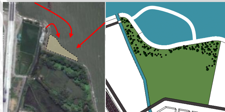
Gambar 4.27 Kendala penumpukan sedimentasi dan solusi pemberian barrier
