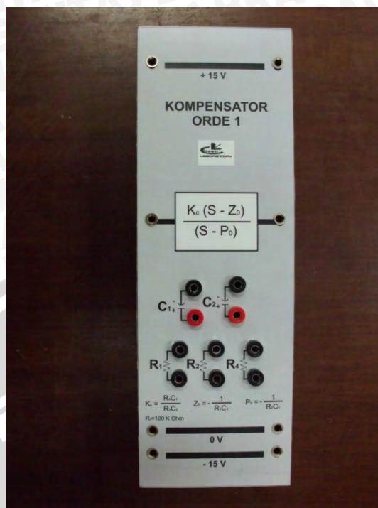
Gambar Hasil Perancangan Modul Kompensator Orde 1
