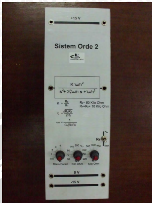
Gambar Hasil Perancangan Modul Sistem Orde 2
