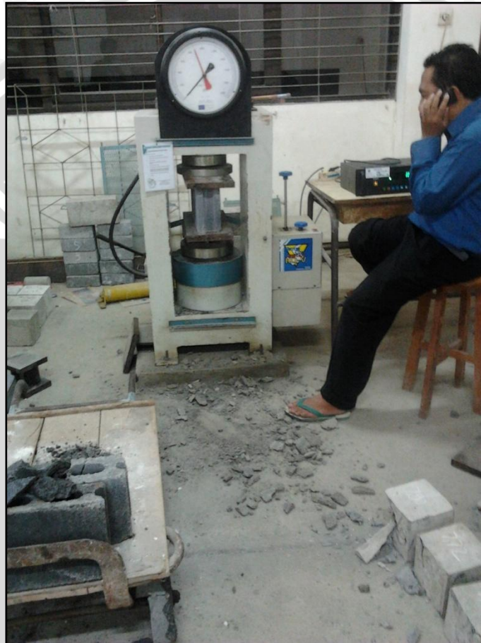
Gambar 4.10 Pengujian kuat tekan batako
