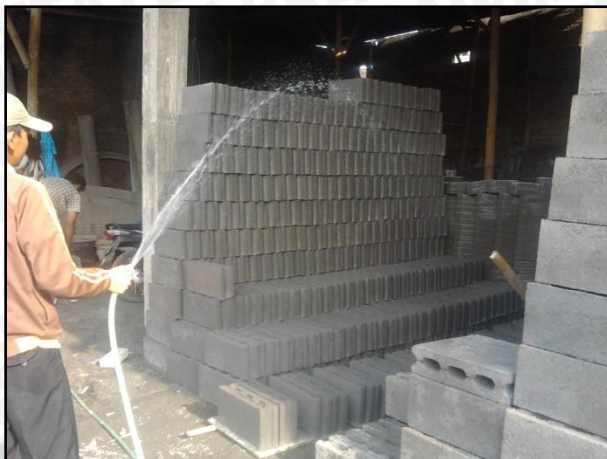
Gambar 4.9. Proses curring pada batako
