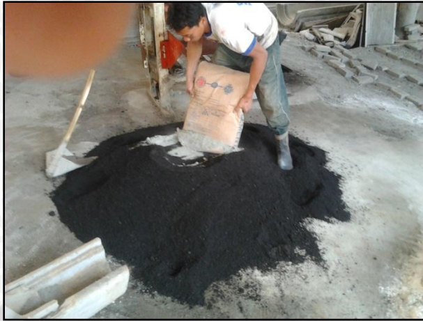
Gambar 4.5. Komposisi bahan pembuatan batako
