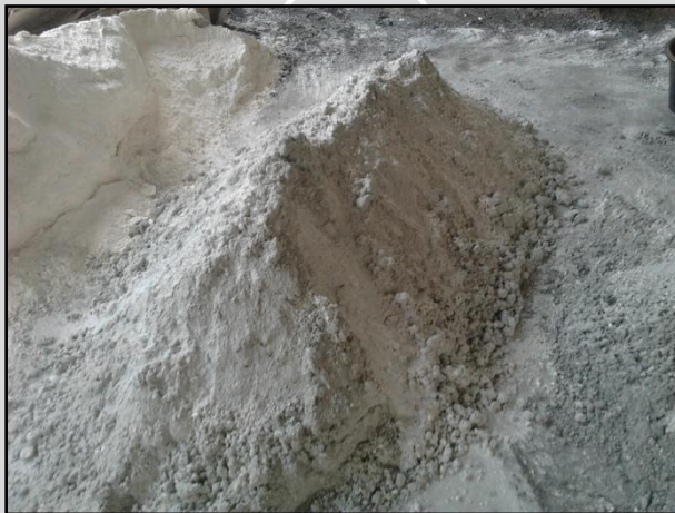
Gambar 4.6. Adonan bahan pembuatan batako
