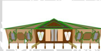
Proporsi yang terbentuk pada bangunan ini memiliki ketinggian keseluruhannya 14 m. tinggi bangunan dari lantai bawah ke lantai ruang 3 m, sedangkan dari lantai ruang ke plafon 8 m. tinggi dari palfon ke atap 6 m.
