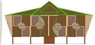
Proporsi yang terbentuk pada bangunan ini memiliki ketinggian keseluruhannya 14 m. tinggi bangunan dari lantai bawah ke lantai ruang 2 m, sedangkan dari lantai ruang ke plafon 6 m. tinggi dari palfon ke atap 6 m.
