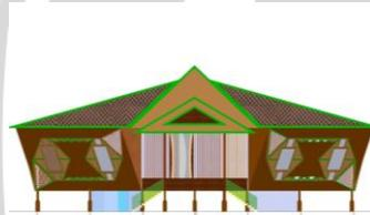
Proporsi yang terbentuk pada bangunan ini memiliki ketinggian keseluruhannya 14 m. tinggi bangunan dari lantai bawah ke lantai ruang 2 m, sedangkan dari lantai ruang ke plafon 6 m. tinggi dari palfon ke atap 6 m.
