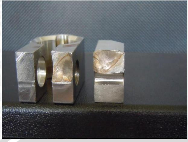
Gambar 1.3 Gambar Patahan *Gripper*
