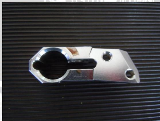
Gambar 3.3 Gambar *Failure Gripper* Tampak Bawah
