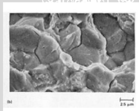
Gambar 2.6 Patahan *decohesive rupture* pada batas butir dengan perbesaran 25 mikro
