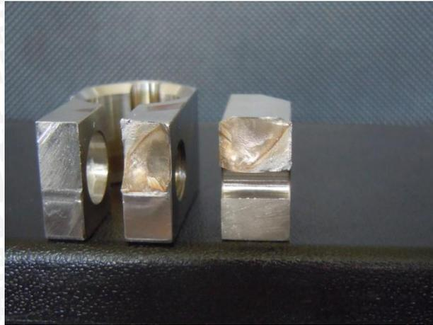
Gambar 3.7 Gambar Patahan *Gripper*
