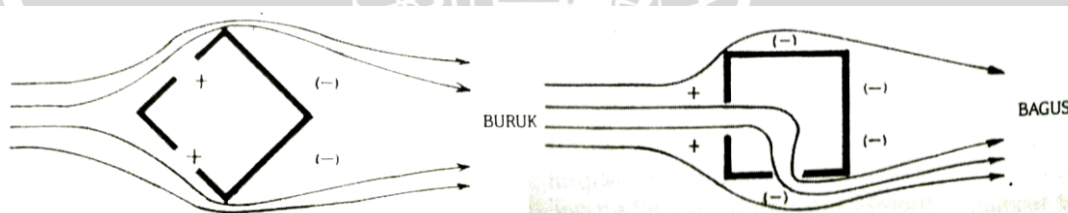
Gambar 2.15 Ventilasi jendela bergantung dari distribusi tekanan terhadap arah angin sumber: Lechner, N., 2007
