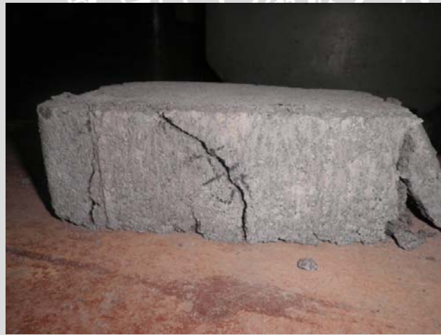
Gambar 4.4 Paving setelah diuji kuat tekan
