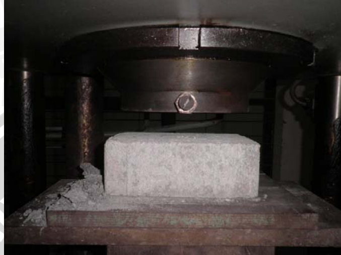
Gambar 4.3 Skema pengujian kuat tekan paving
