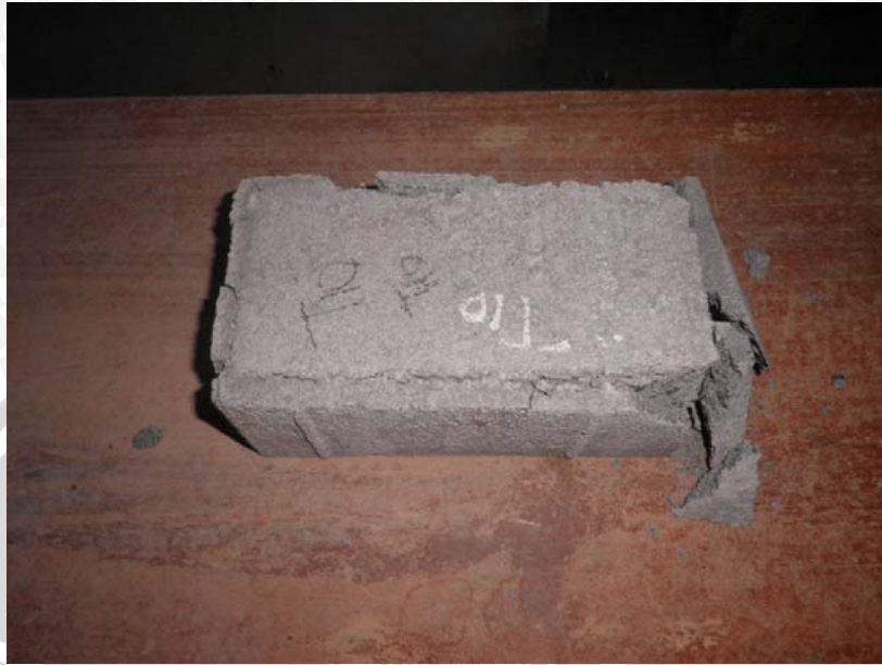
Gambar Paving semen jenis B yang Hancur setelah di Uji tekan
