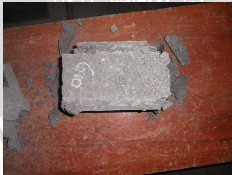
Gambar Paving semen jenis A yang Hancur setelah di Uji tekan
