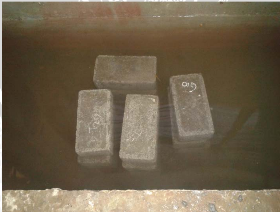
Gambar paving yang direndam setelah di oven
