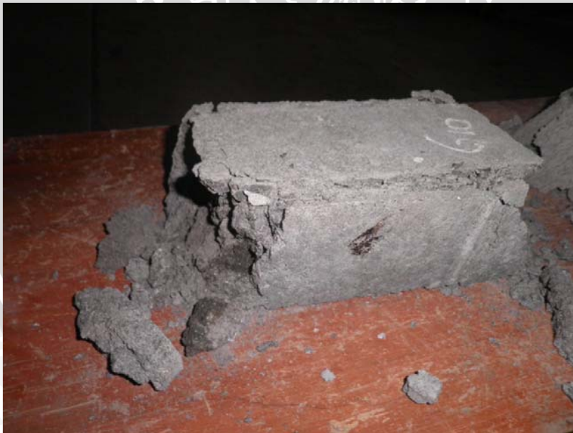
Gambar Paving semen jenis C yang Hancur setelah di Uji tekan
