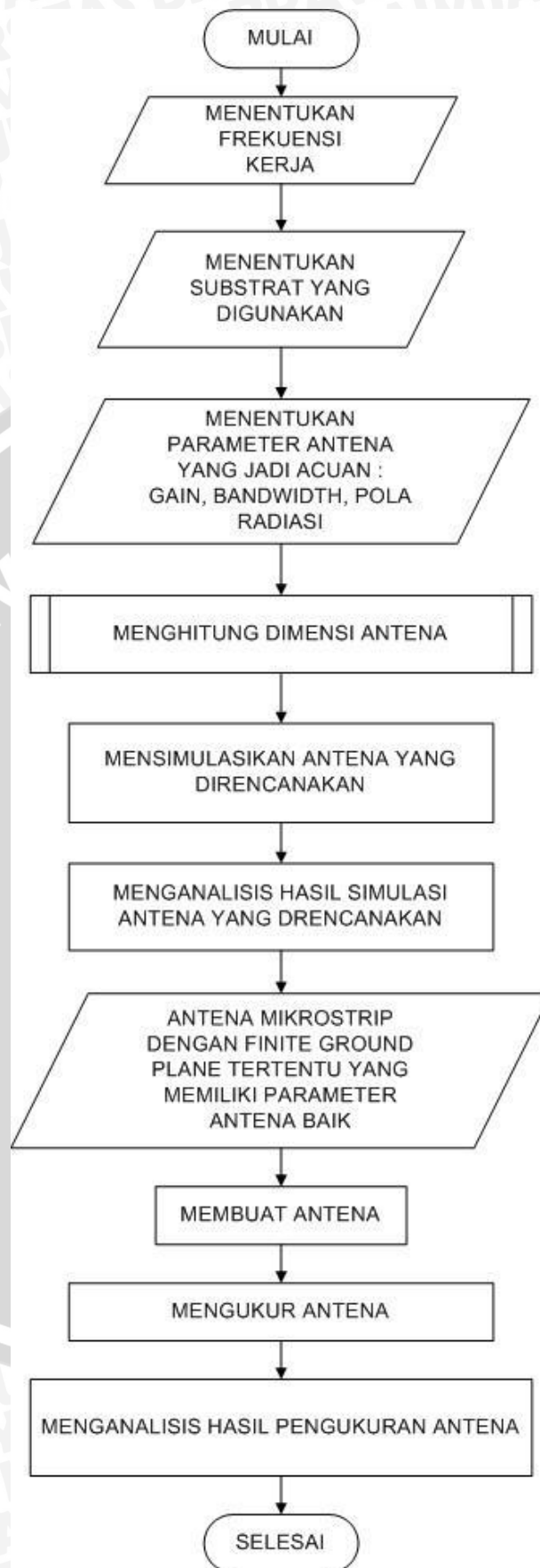
Gambar 3.4 Diagram Alir Perencanaan dan Pembuatan Antena Mikrostrip
