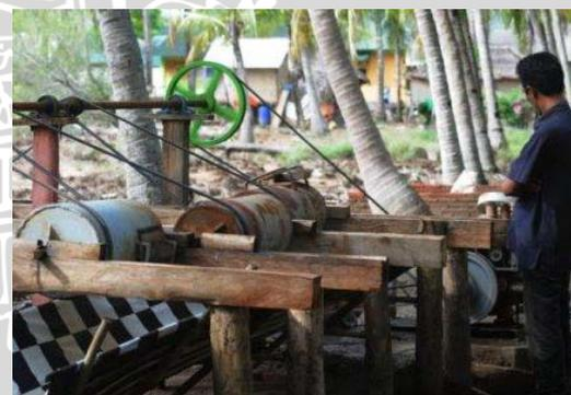
Gambar 4. 38 Peralatan Pendulang Emas (Mesin Gelondongan)
