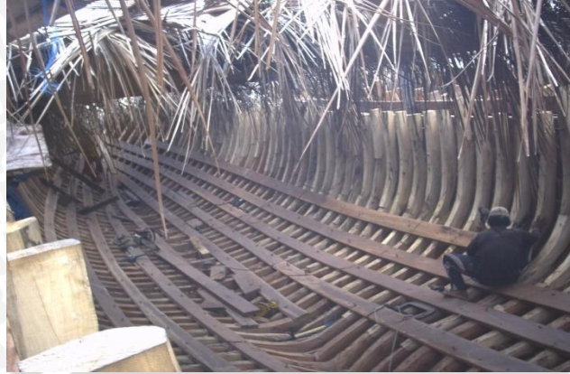
Gambar 4.22 Gading dan Galah yang Mengikat Lambung
