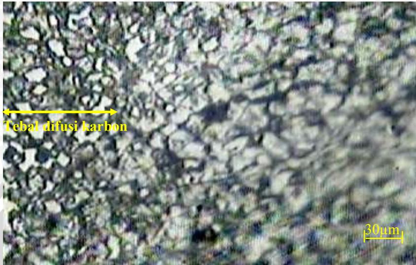
Foto mikro hasil *pack carburizing* pada suhu 800°C dengan *carburizer* berukuran 60-100µm
