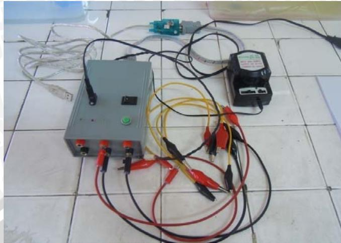
Gambar 3.13 Alat akusisi pencatat tegangan dan temperatur
