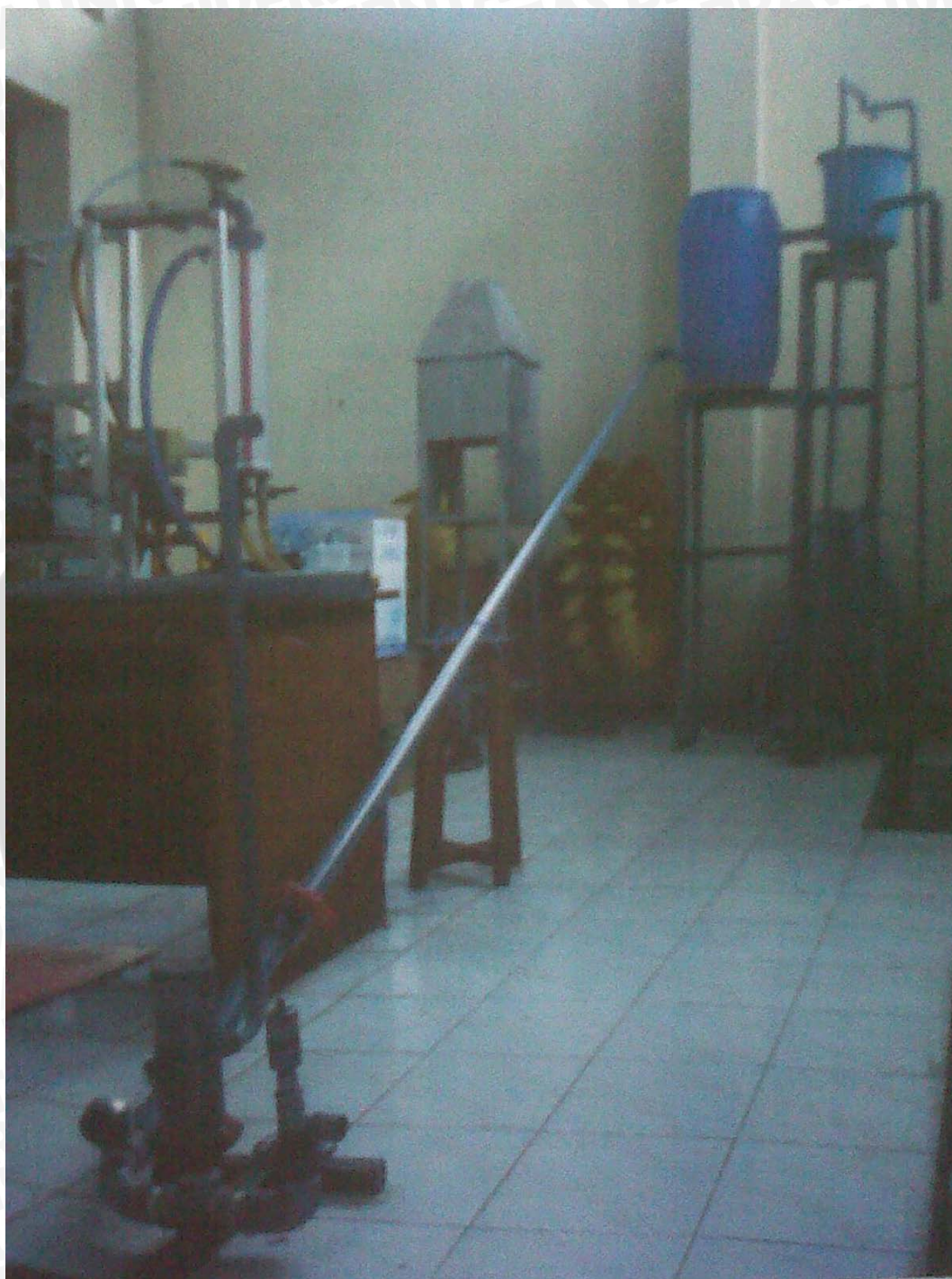
Lampiran 1. Foto instalas pompa hidram.
