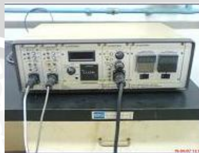
Gambar 3.8: Alat uji korosi Potensiostat
