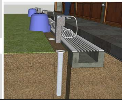
Aplikasi lubang resapan biopori pada edge (tepi) taman berfungsi untuk mempercepat daya serap tanah, sehingga mencegah kemungkinan timbulnya genangan air saat hujan.
