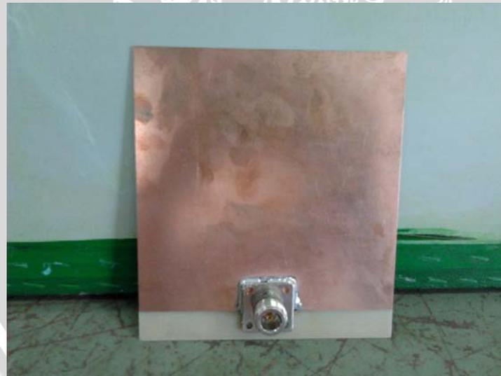
Gambar 9 Tampak depan antenna *Microstrip Rectangular Patch* dengan *Finite Ground Plane*  $1\lambda_0 \times 1\lambda_0$  hasil fabrikasi
