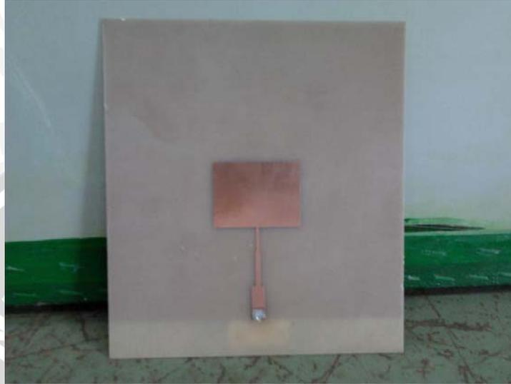
Gambar 8 Tampak depan antenna *Microstrip Rectangular Patch* dengan *Finite Ground Plane*  $1\lambda_0 \times 1\lambda_0$  hasil fabrikasi
