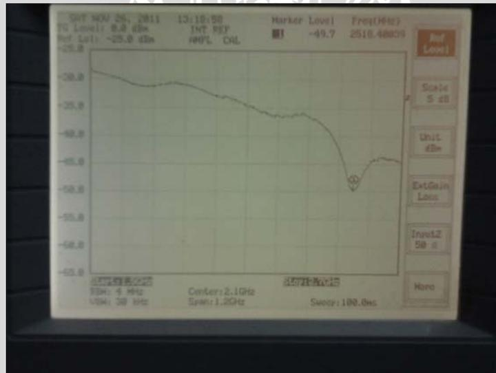
Gambar 11 Hasil Pengukuran  $S_{11}$  pada rentang 1,5 GHz – 2,7 GHz
