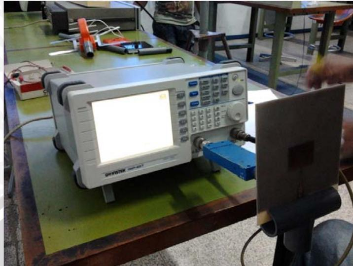
Gambar 10 Antena yang terhubung dengan *Spectrum Analyzer* GSP-827
