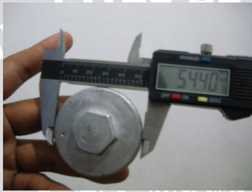
Gambar 4.10 Pengukuran Dimensi lingkaran Benda Coran
