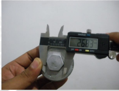
Gambar 4.9 Pengukuran Dimensi Segi Enam Benda Coran
