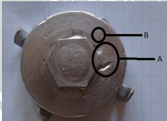
Gambar 4.6 Gambar Cacat Permukaan Hasil Coran, (A) Cacat Rongga Udara, (B) Cacat Lubang Jarum
