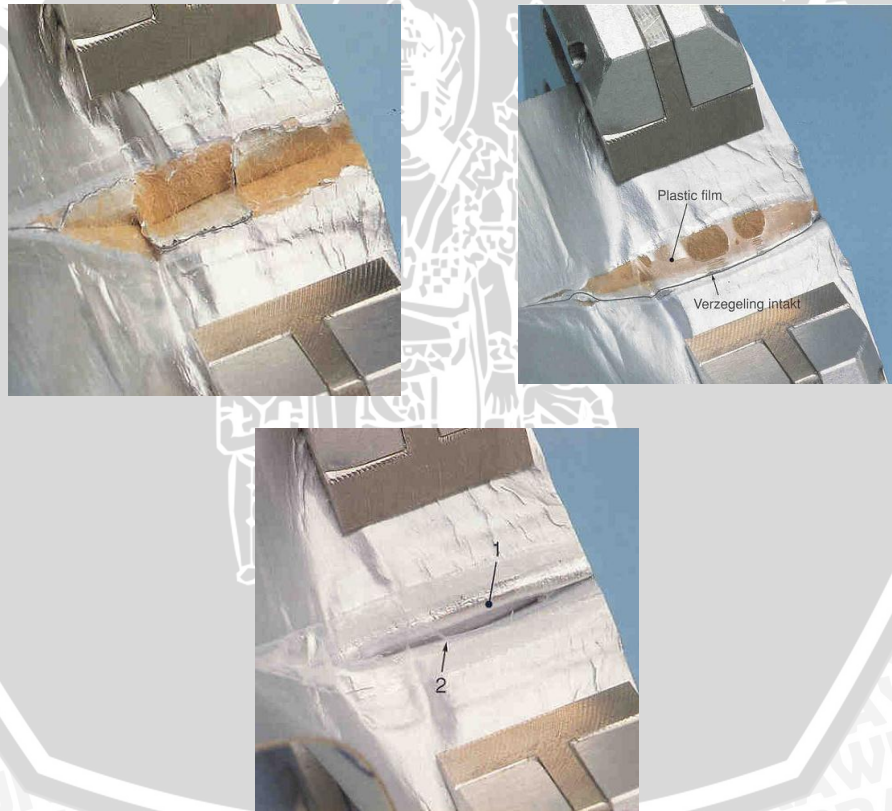
Gambar 2.5 Gambar Seal yang baik Sumber: PT Greenfields Indonesia, 2011
