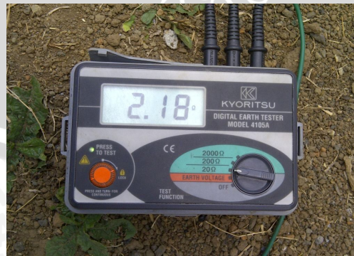
Gambar L.5.2 Hasil Pengukuran Tahanan Kaki Tower 3 (Oktober 2011)
