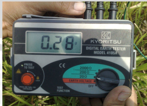
Gambar L.3.2 Hasil Pengukuran Tahanan Kaki Tower 1 (Oktober 2011)
