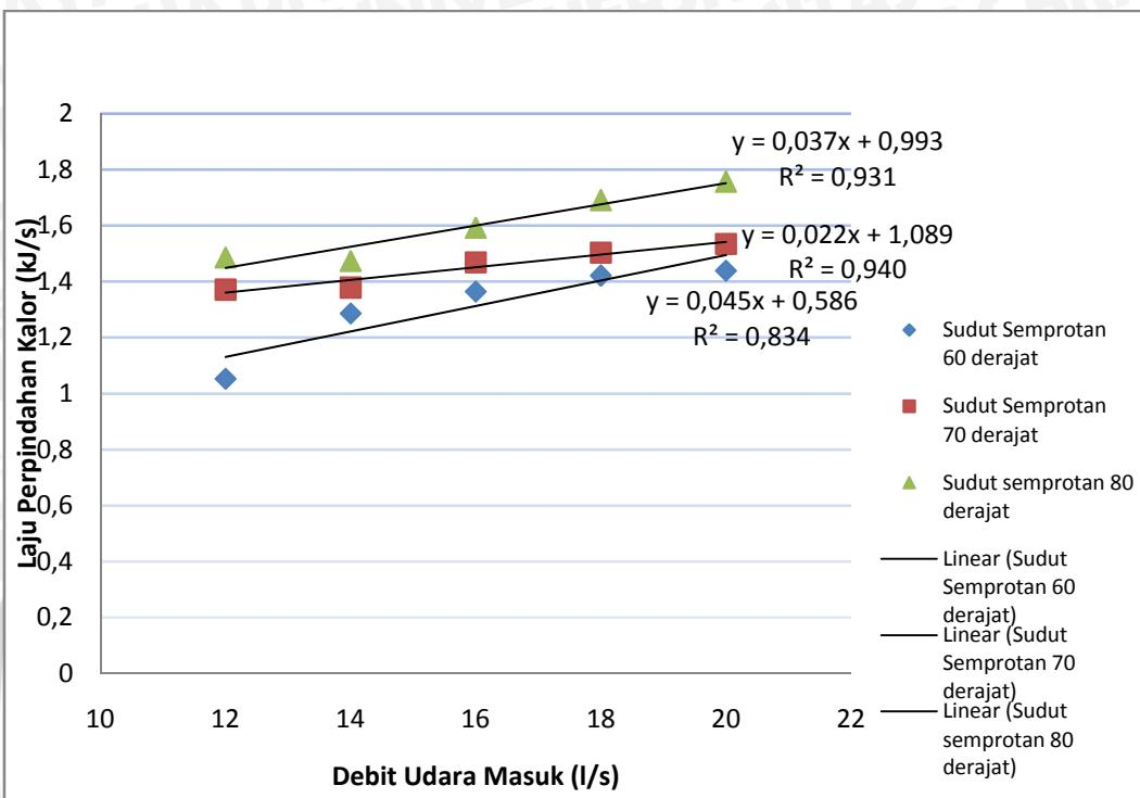
Gambar 4.1 Grafik pengaruh sudut semprotan air dan debit udara masuk terhadap laju perpindahan kalor *cooling tower*
