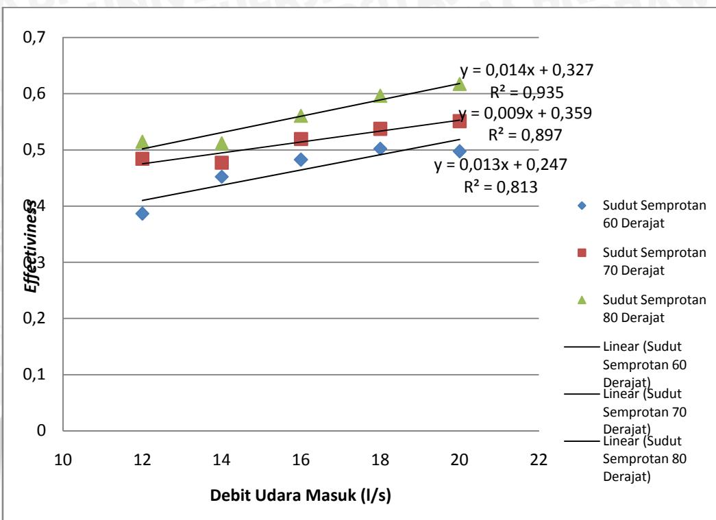
Gambar 4.2 Grafik pengaruh sudut semprotan air dan debit udara masuk terhadap efektivitas (*effectiveness*) *cooling tower*
