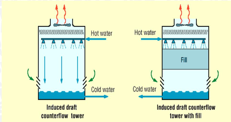
Gambar 2.2. *Induced draft Cooling tower* dengan aliran berlawanan.
