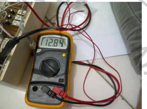
Gambar 5.18 Pengukuran V Driver pada Logic 0
