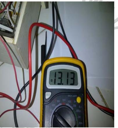
Gambar 5.21 Pengukuran V Driver pada Logic 0
