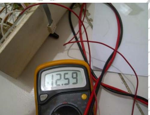
Gambar 5.25 Pengukuran V Relay pada Logic 1
