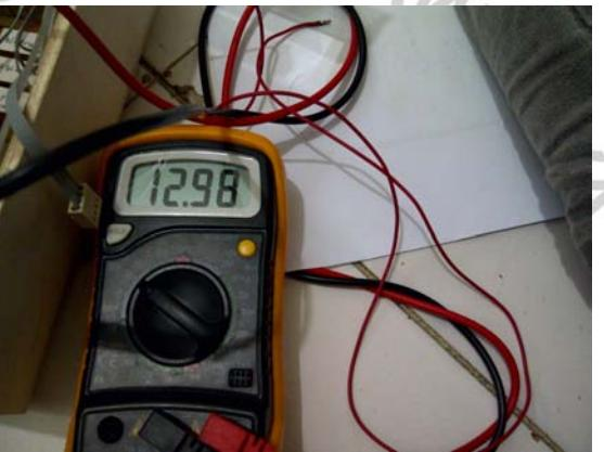
Gambar 5.15 Pengukuran V Driver pada Logic 0
