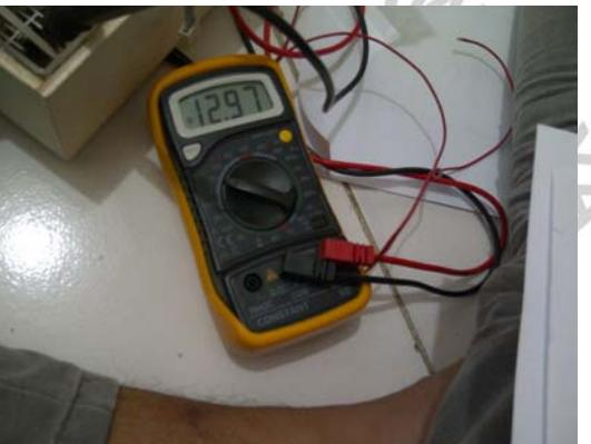
Gambar 5.24 Pengukuran V Driver pada Logic 0
