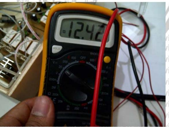
Gambar 5.19 Pengukuran V Relay pada Logic 1
