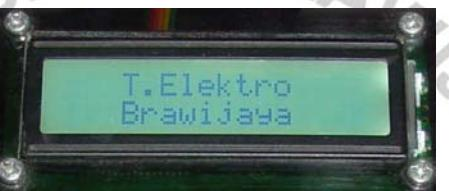
Gambar 5.4 Hasil Pengujian Antarmuka Modul LCD
