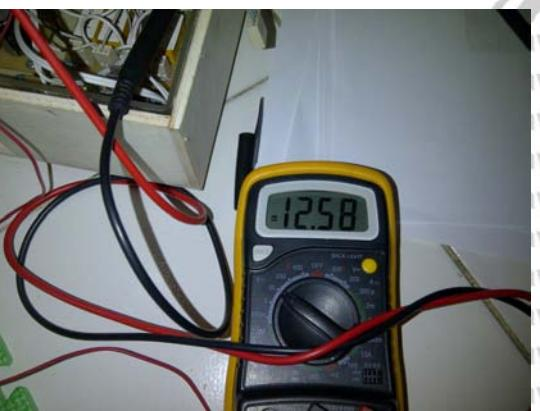
Gambar 5.16 Pengukuran V Relay pada Logic 1
