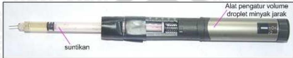
Gambar 3.1 Alat pembentuk *droplet* minyak kelapa
