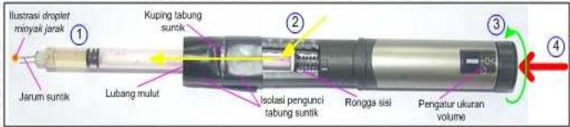
Gambar 3.4 Alat pembentuk droplet minyak kelapa
