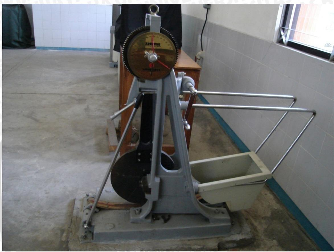
Gambar mesin uji *impact*
