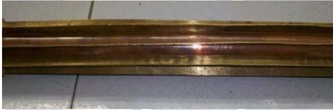
Gambar A. Inner Tube dengan Penambahan Longitudinal Fin
