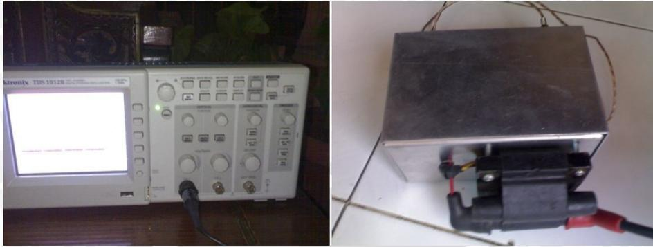
Gambar 3.2 : *Oscilloscope* dan *Ion Probe*
