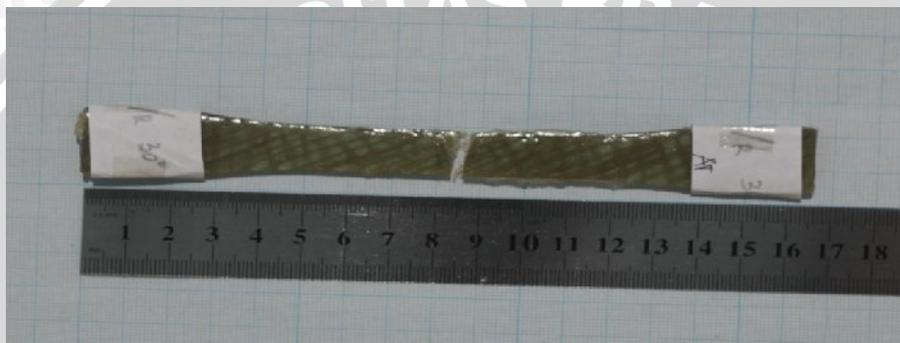
Gambar 4.11 Spesimen dengan orientasi sudut  $30^\circ$  dengan metode penyusunan SA/SR setelah diuji tarik
