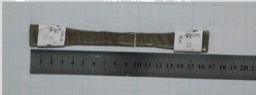
Gambar 4.5 Spesimen dengan orientasi sudut  $10^\circ$  dengan metode penyusunan SR/SA setelah diuji tarik
