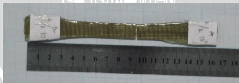
Gambar 4.9 Spesimen dengan orientasi sudut 10° dengan metode penyusunan SA/SR setelah diuji tarik
