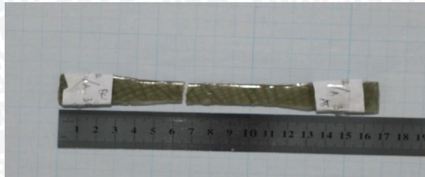
Gambar 4.7 Spesimen dengan orientasi sudut 30° dengan metode penyusunan SR/SA setelah diuji tarik
