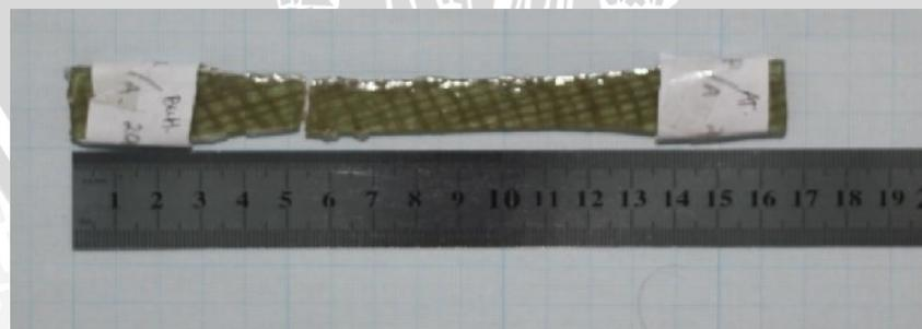
Gambar 4.6 Spesimen dengan orientasi sudut  $20^\circ$  dengan metode penyusunan SR/SA setelah diuji tarik
