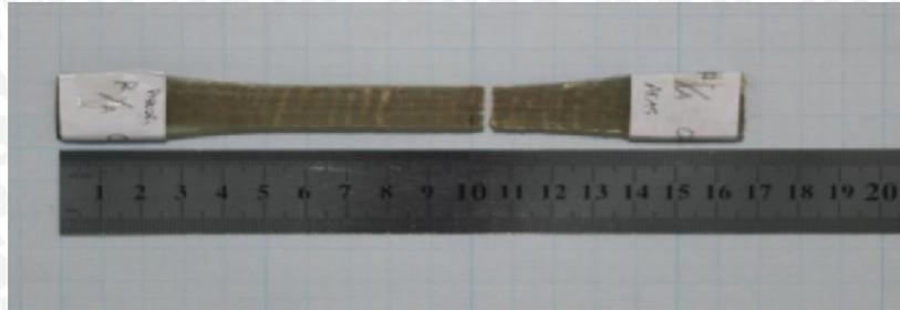
Gambar 4.4 Spesimen dengan orientasi sudut  $0^\circ$  dengan metode penyusunan SR/SA setelah diuji tarik
