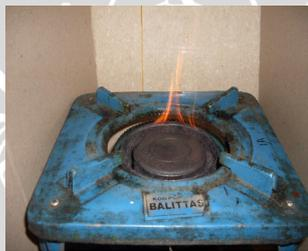
Gambar 2. Nyala api pada kompor dengan jumlah lubang udara 335 buah
