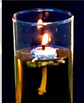
Gambar 2.6 Pembakaran difusi pada minyak jarak
