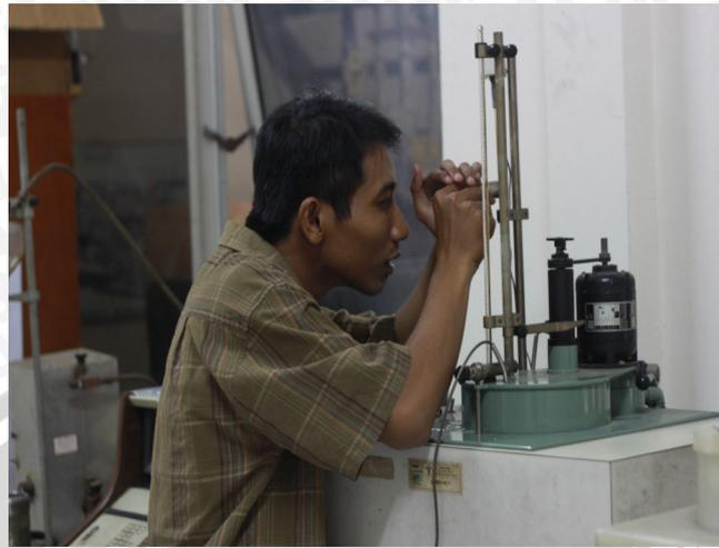
Gambar 1. Pengujian memakai *bomb calorimeter*
