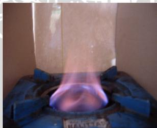
Gambar 3. Nyala api pada kompor dengan jumlah lubang udara 376 buah
