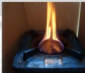
Gambar 4. Nyala api pada kompor dengan jumlah lubang 458 buah
