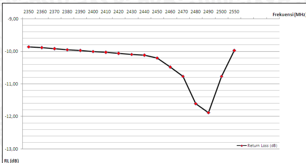
Gambar 5.2 Grafik Fungsi Return Loss Terhadap Frekuensi Sumber : Hasil Pengukuran
