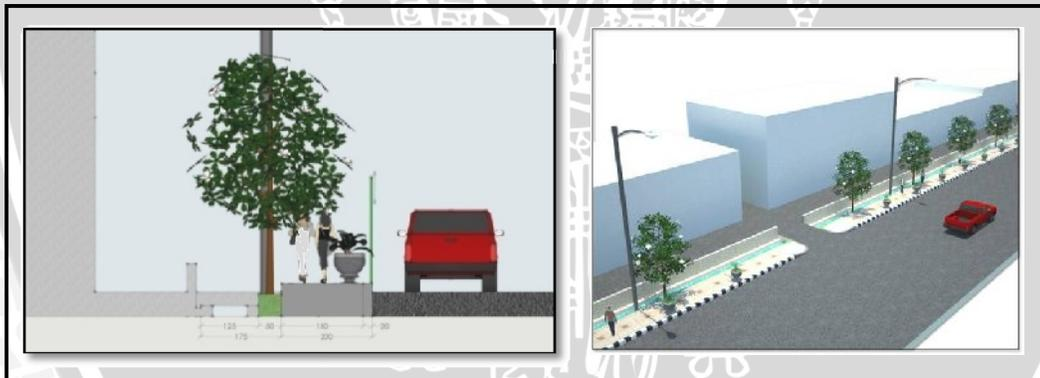
Gambar 4.27 Pedestrian dengan lebar 2 meter
