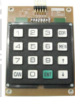
Gambar 4.8 Susunan tombol pada keypad 4x4
