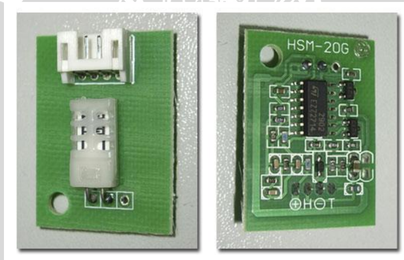
Gambar 2.5. Sensor Suhu dan Kelembaban HSM20G
