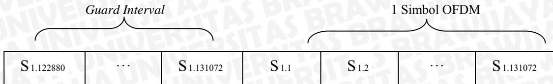
Gambar 3.8 Penyisipan *Guard Interval* 1/16 pada Simbol OFDM
