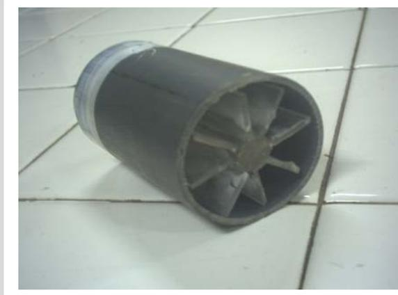
*Vane* tipe *Etoile Flow Straightener* dengan 8 sirip/plat dan diameter 31,75 mm dan panjang 63,5 mm
