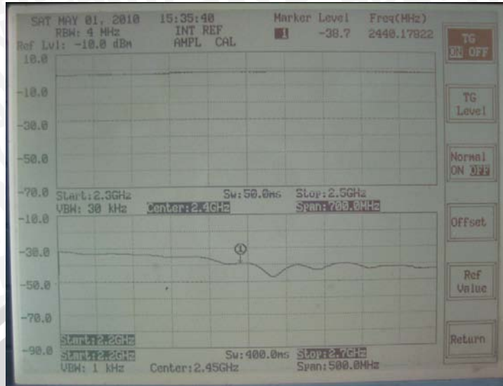
Gambar 53 : Hasil Pengukuran Return Loss (2 layar) pada Rentang 2,2 GHz – 3 GHz
