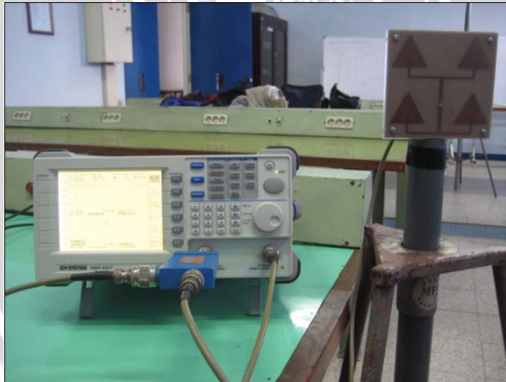
Gambar 52 : Antena Mikrostrip Equilateral Triangular Array yang terhubung dengan
