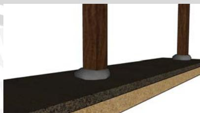
Gambar 4.75. Pondasi Umpak batu kali pada rumah Tipe 2
