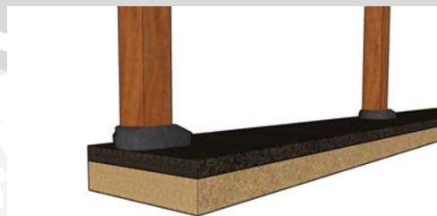
Gambar 4.69. Pondasi Umpak batu kali pada rumah Tipe 1
