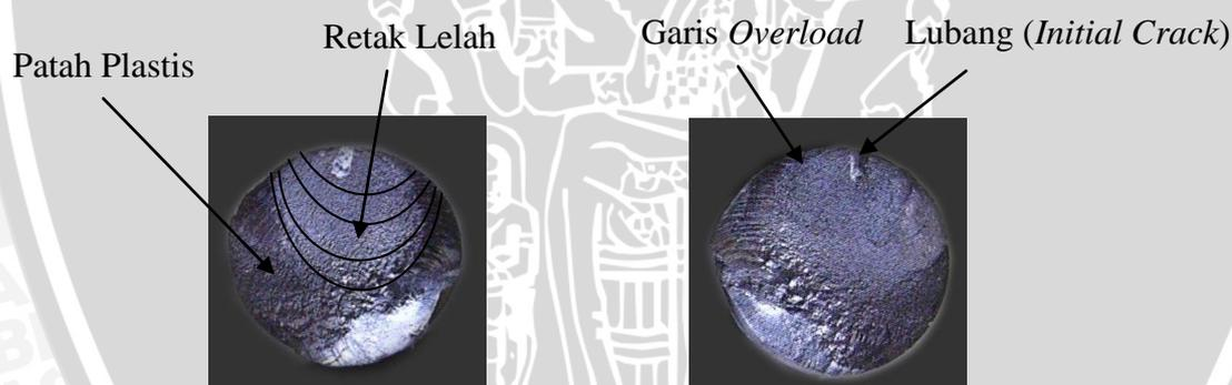
Gambar 4.5. Bentuk patahan hasil pengujian
